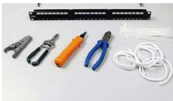
Figura. 4.11 Herramientas de ponchado para el patch panel
