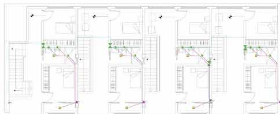
INSTALACIONES HIDROSANITARIAS SIN ESCALA NIVEL -6.50
