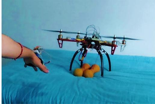
*Nota:* La figura presenta la prueba realizada para observar el comportamiento del dron cuando se inclina la mano hacia abajo por lo que indica al dron desplazarse adelante. En este caso se puede visualizar que los motores traseros presentan mayor potencia que los delanteros.
