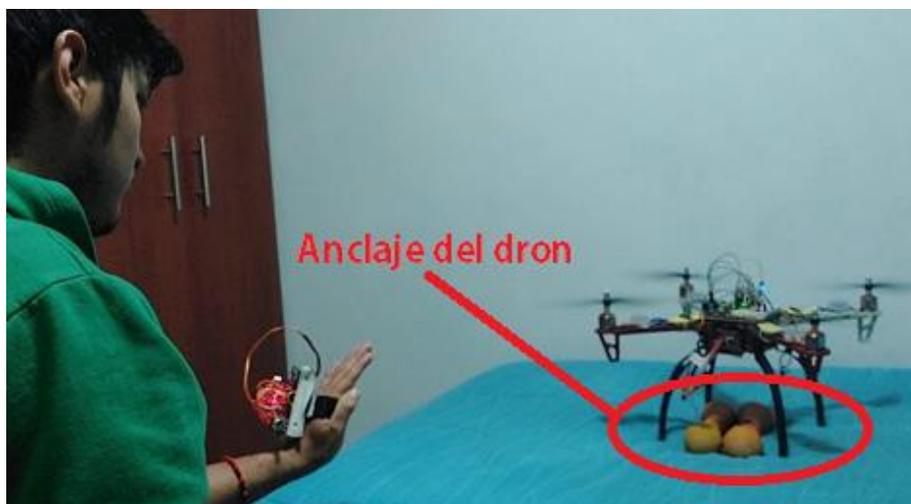
El funcionamiento principal del dron se puede visualizar de mejor forma en el diagrama 12, en donde se indica la configuración de la comunicación del sistema general. En donde, el envío de datos se realiza en un solo sentido es decir que el mando se encarga de enviar valores sin necesidad de recibir señales. En este mismo sentido, el dron se encarga de recibir datos mas no de enviarlos.
