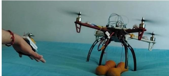
Tras verificar el correcto funcionamiento del dron, se procedió a evaluar tres aspectos fundamentales: autonomía de la batería, distancia de alcance máxima y control por gestos manuales. Para ello, se implementó un Diseño de Experimentos (DOE) como se muestra en el diagrama 9 con el objetivo de determinar la relación entre la potencia utilizada por los motores y la duración de la batería.
