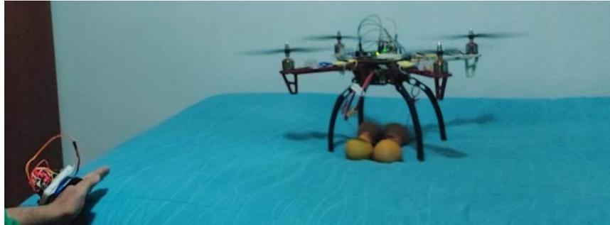
*Nota:* La figura presenta la prueba realizada para observar el comportamiento del dron cuando se inclina la mano hacia la izquierda por lo que indica al dron desplazarse en esa dirección. En este caso se puede visualizar que los motores derechos presentan mayor potencia que los izquierdos.
