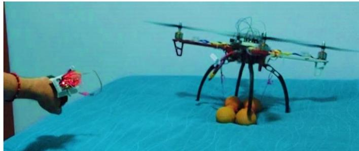
*Nota:* La figura presenta la prueba realizada para observar el comportamiento del dron cuando se inclina la mano hacia la derecha por lo que indica al dron desplazarse en esa dirección. En este caso se puede visualizar que los motores izquierdos presentan mayor potencia que los derechos.
