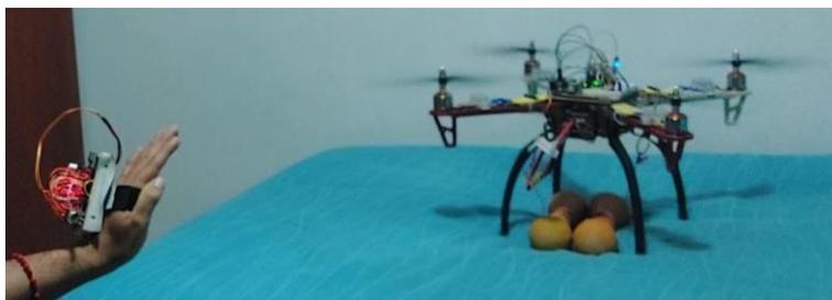
*Nota:* La figura presenta la prueba realizada para observar el comportamiento del dron cuando se inclina la mano hacia arriba por lo que indica al dron desplazarse atrás. En este caso se puede visualizar que los motores delanteros presentan mayor potencia que los traseros.
