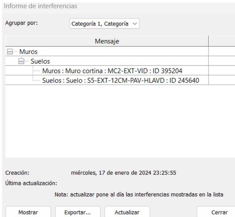
Nota: En la imagen se muestra el informe obtenido luego de realizar el análisis de interferencias entre los muros y suelos de arquitectura, se puede observar que el resultado fue de una interferencia encontrada. Autor
