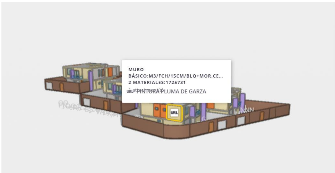
Ilustración 4: Selección de una pared (resaltado en amarillo) y el detalle técnico a la derecha
