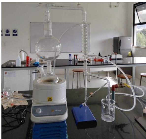
Figura 1 se ilustra el montaje del equipo de destilación por arrastre con vapor empleado para la extracción de aceites esenciales. La totalidad de la instrumentación y materiales de laboratorio necesarios fueron suministrados gentilmente por la Universidad Internacional SEK de Ecuador.
