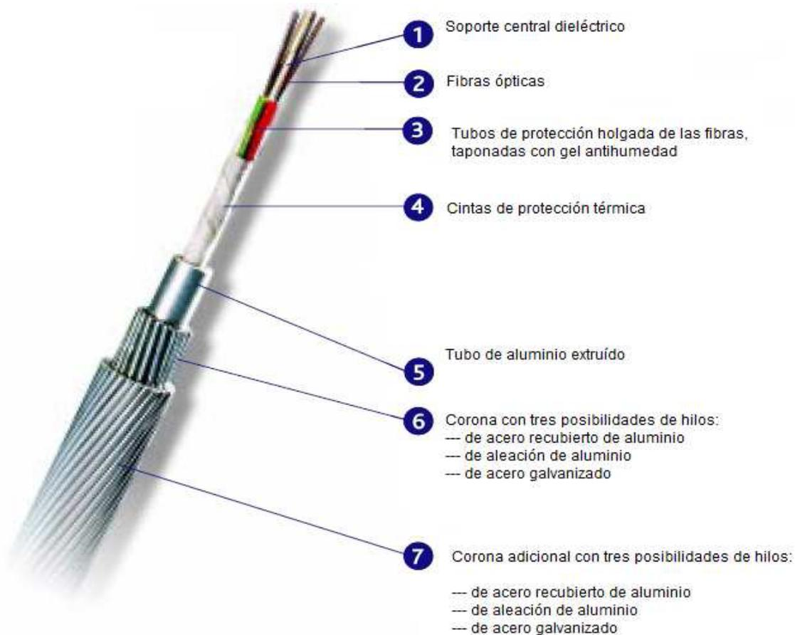
**Cable óptico OPGW conformado por el núcleo óptico y la protección metálica**
