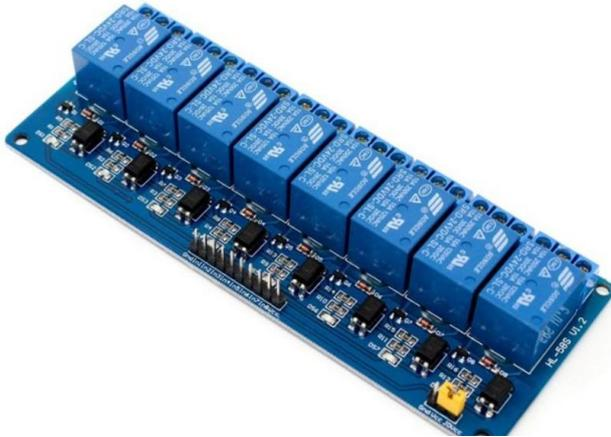
*Nota: La figura muestra un módulo de 8 relés con optoacopladores (Components 101, 2021).*
