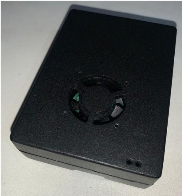
Una vez que se soluciona el problema del calentamiento se evitan posibles daños en el hardware del microprocesador, además tenemos una mejora en el procesamiento de datos del dispositivo, ya que contamos con un sistema de ventilación adecuado para el procesador de la tarjeta.
