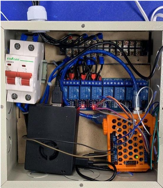
El circuito de control se encarga de controlar el flujo normal de programación del semáforo, además de actuar con las interrupciones detectadas con el microcontrolador. Se observa el circuito de potencia en la Figura 33.
