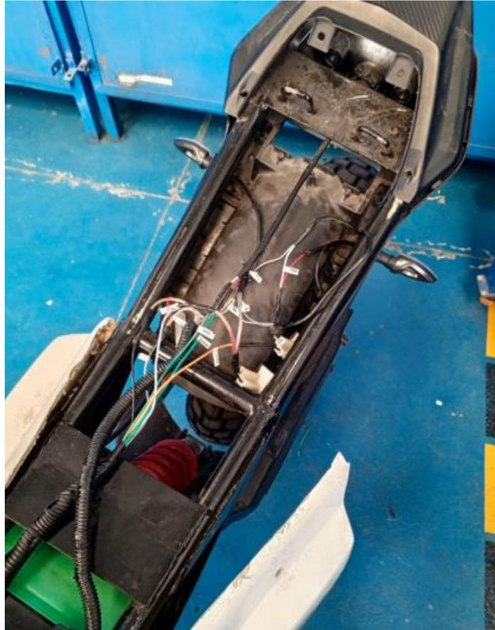
*Nota.* Se pueden observar los cables del arnés los cuales conectan las direccionales traseras, los Flasher y la luz de freno además de se observa una parte la cual va hacia adelante a alimentar las luces Frontales
