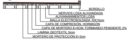
C7 A1 CORTE ACABADO DE CUBIERTAS
