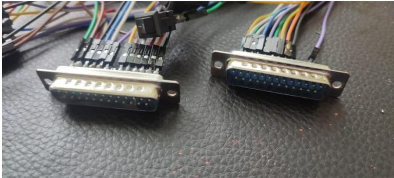
**Activación de las señales provenientes de la ECU.** Las señales son de 5 V para la bobina y el inyector. Para tal efecto, Arduino acondiciona una tensión máxima de 3.3 V con el fin de simular la señal.
