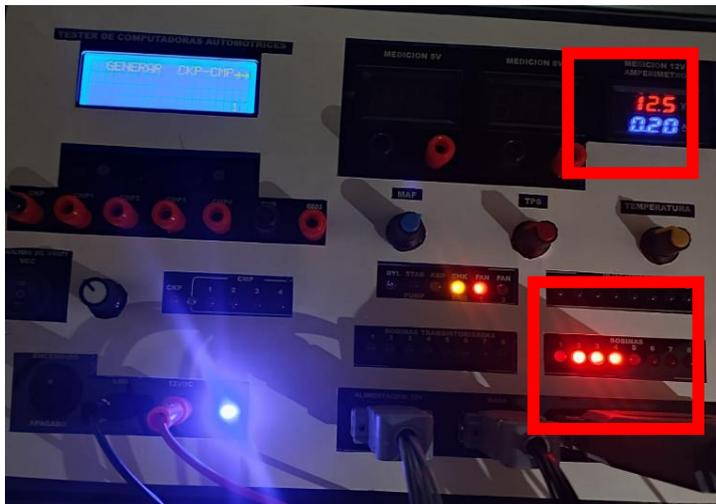
Enseguida, se confirmó el funcionamiento de los microcontroladores de activación de inyectores al conectar los actuadores. También, fueron conectadas las bobinas y pudo evidenciarse que el microcontrolador de activación no funcionaba porque no emite la señal necesaria. Asimismo, se identificó el recalentamiento de un driver y de la memoria cuando la computadora tiene alimentación (Figura 60).
