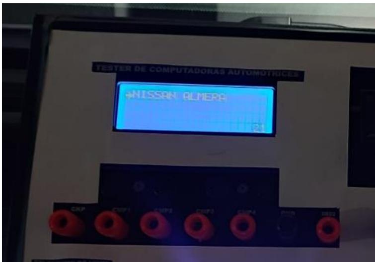
Posteriormente, el banco de pruebas fue encendido y se aumentó la velocidad para simular la aceleración del vehículo y emitir la señal del sensor CKP para corroborar que los actuadores trabajen correctamente (Figura 58).
