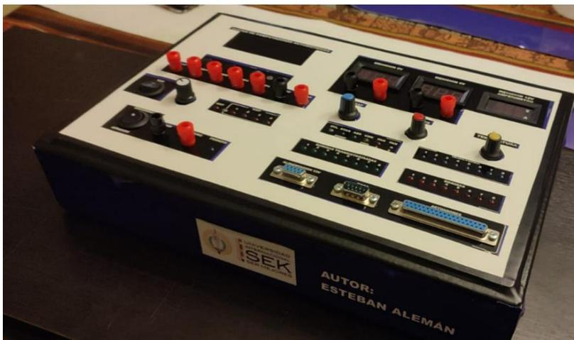
**Generación de señales CKP.** Fue realizada la simulación de la señal sensor CKP efecto hall; se realizó la respectiva programación, la cual muestra su onda (Figura 52).
