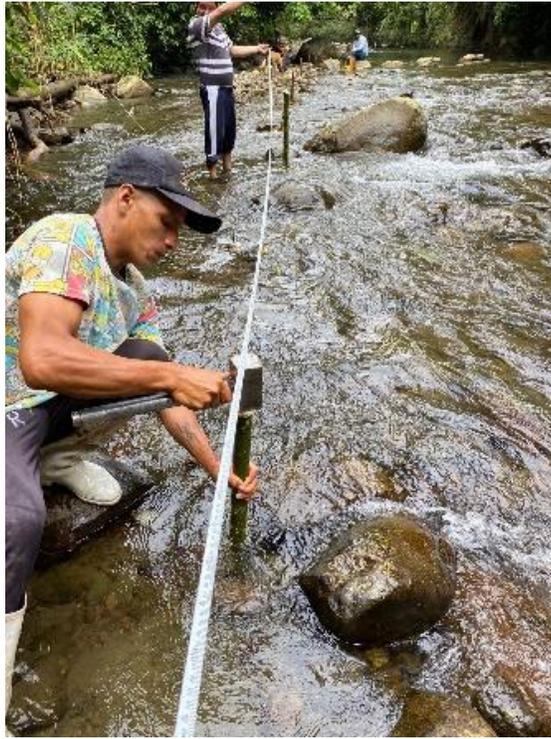
En la figura 21 se puede observar la división que se ha realizado a lo largo del río, en donde se divide en 6 secciones, contando desde la sección 0 que corresponde al punto inicial.
