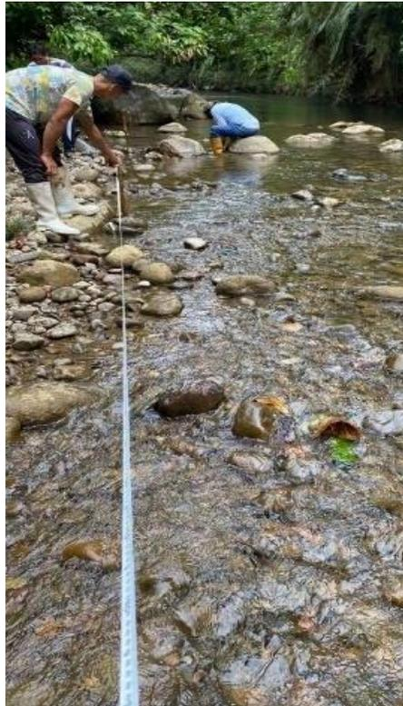
Con el ancho del río y la longitud útil sin obstáculos se procede a clavar las estacas a lo largo del tramo donde se va a obtener el caudal, con una distancia de 5 metros entre cada estaca, en los dos costados del río:
