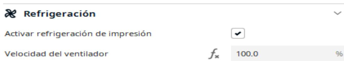
*Nota.* En cualquier filamento (a excepción de ABS) necesita una velocidad del 100%
