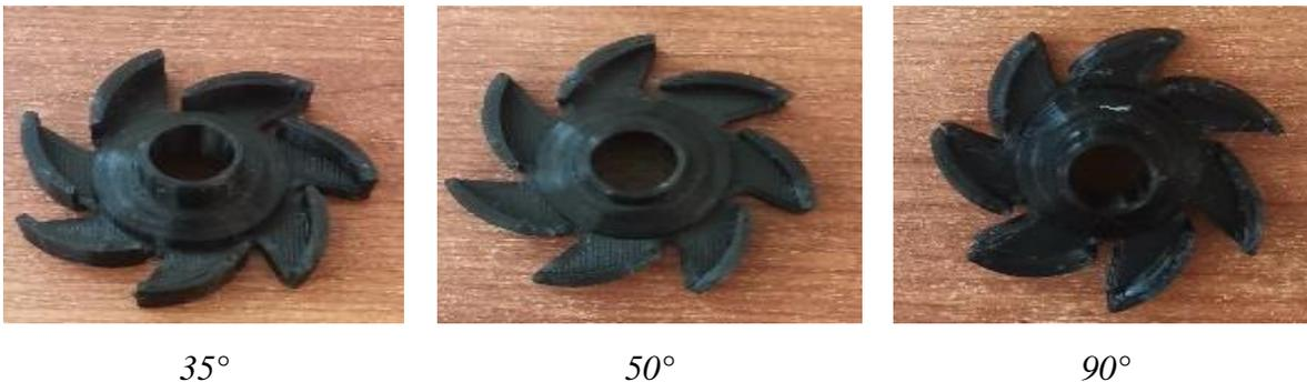
*Nota. Impulsores para pruebas de temperatura a 35°, 50° y 90°*
