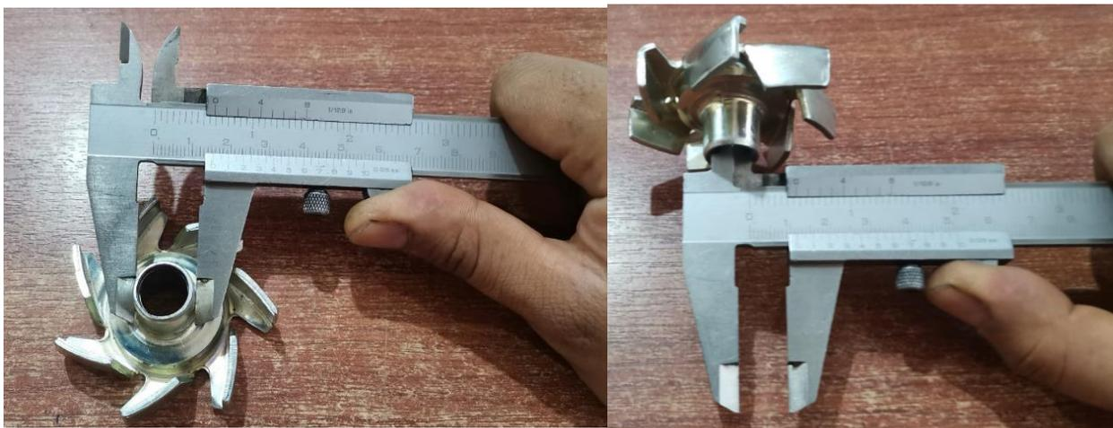
*Nota.* Muestra la forma de medición del impulsor
