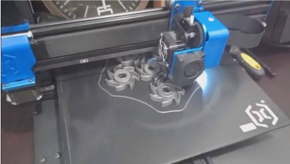
*Nota.* en la figura se muestra la base del impulsor de bomba y la placa de la impresora
