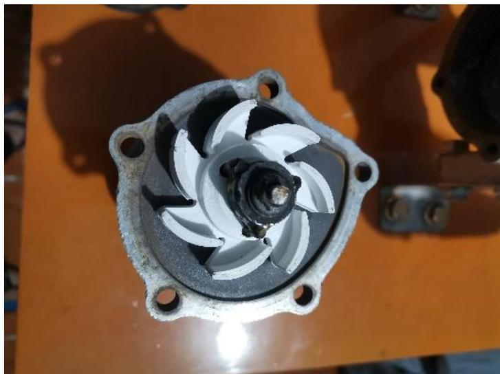
*Nota. Montaje de impulsores para la prueba hasta los 90 grados*
