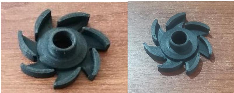
*Nota.* en la figura se muestra la base del impulsor de bomba y la placa de la impresora
