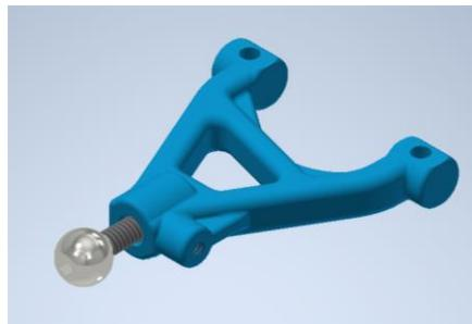
*Nota.* La figura 36 ejemplifica el marco inferior de suspensión delantera perteneciente al Hyundai Elantra HDR 1.6 2010, diseñado en el software CAD “Autodesk Inventor”.
