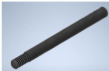
*Nota.* La figura 31 ejemplifica el pasador del eje del amortiguador de la suspensión delantera perteneciente al Hyundai Elantra HDR 1.6 2010, diseñado en el software CAD “Autodesk Inventor”.
