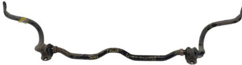
*Nota.* En la figura 10 se aprecia la barra estabilizadora de la suspensión delantera del Hyundai Elantra 1.6 4DR 2010. Tomado de IPAR DESARMADURIA [Figura], por Hyundai, 2007, I.D., S/F, (<https://www.desarmaduriaipar.cl/desarmaduria/repuesto/5363/barra-estabilizadora-delantera-hyundai-elantra-1-6-g4fc-dohc-16-valv-4x2-2006-2007-2008-2009-2010-2011>).
