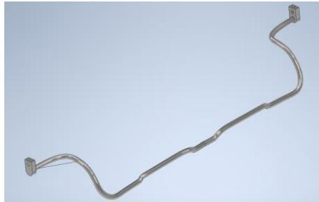
*Nota.* La figura 38 ejemplifica la barra estabilizadora de la suspensión delantera perteneciente al Hyundai Elantra HDR 1.6 2010, diseñado en el software CAD “Autodesk Inventor”.
