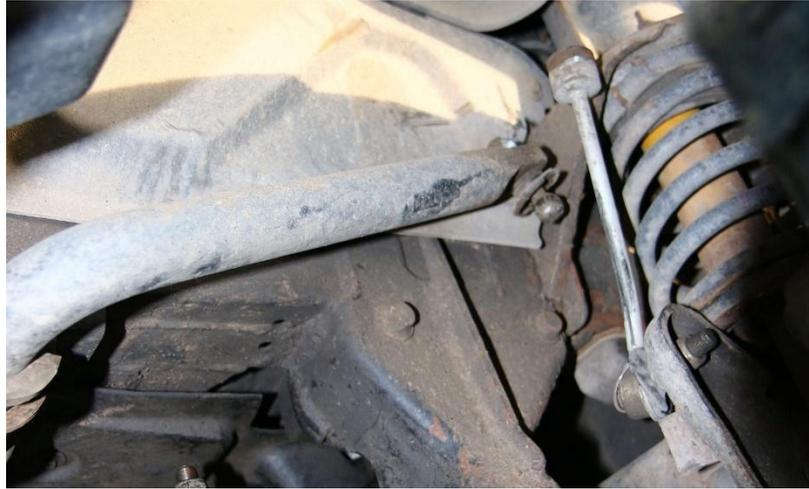
*Nota.* En la figura 12 se aprecia el trabajo que realiza la barra estabilizadora cuando el vehículo se encuentra en marcha. Tomado de Barra Estabilizadora [Fotografía], por L.D., 2021,
