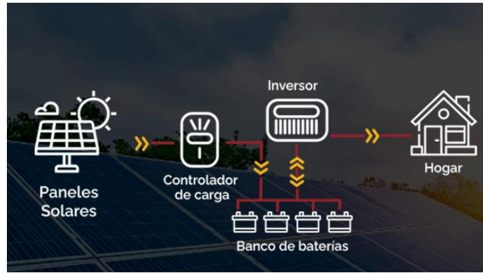
Figura 45 Sistema aislado con batería Auto solar Energy Solutions
