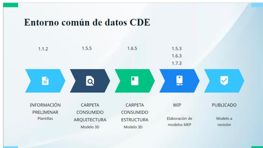
Figura 11 Entorno común de datos CDE Elaboración propia
