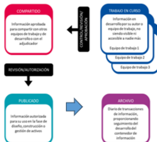
Figura 8 Entorno Común de Datos Fuente: Industrial BIM
