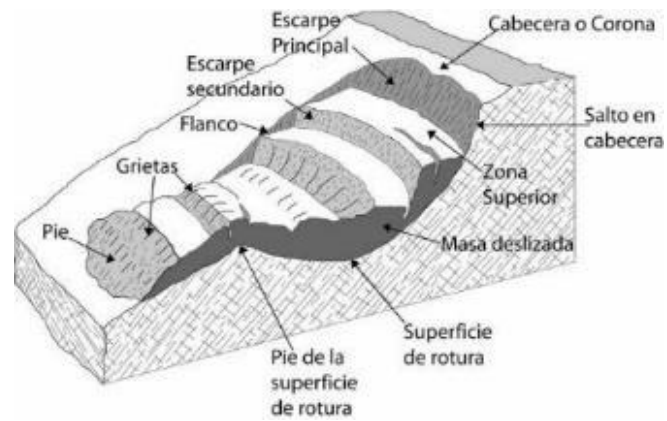
Figura 4. Esquema de un deslizamiento Tomado de: https://www.diccionario.geotecnia.online
