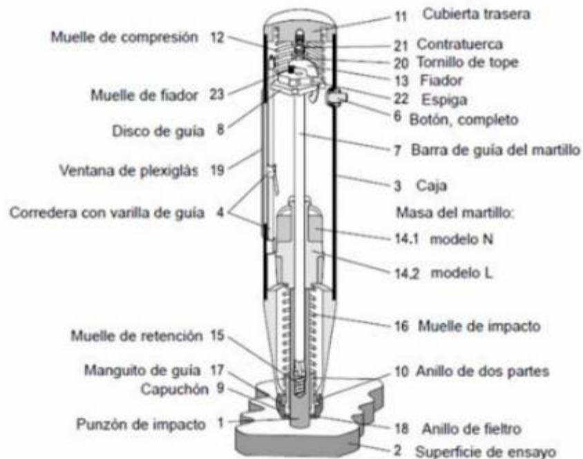
Figura 29. Esquema del martillo de rebote Tomado de: https://www.mercado.geotecnia.online/wp-content/uploads/2020/07/Martillo-Schmidt-Esclero%CC%81metro.pdf
