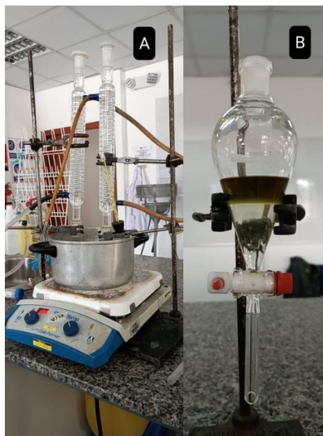
Figura 5. A. Equipo de reflujo para saponificación de biomasa de consorcio. B: separación de la fase acuosa y la fase orgánica después del proceso de extracción.
