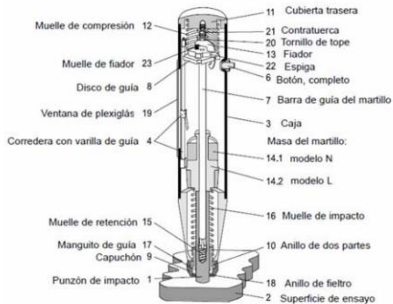
Figura 35.- Partes del Martillo Schmidt.
