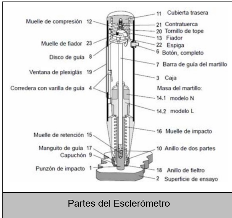
Figura 13. Partes que conforman un Esclerómetro
