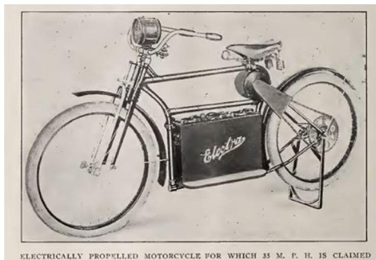
Nota. La Figura 5 muestra una variante de motocicleta eléctrica de 1911 con su batería de 12V. Tomado de (AnySkin, 2016)
