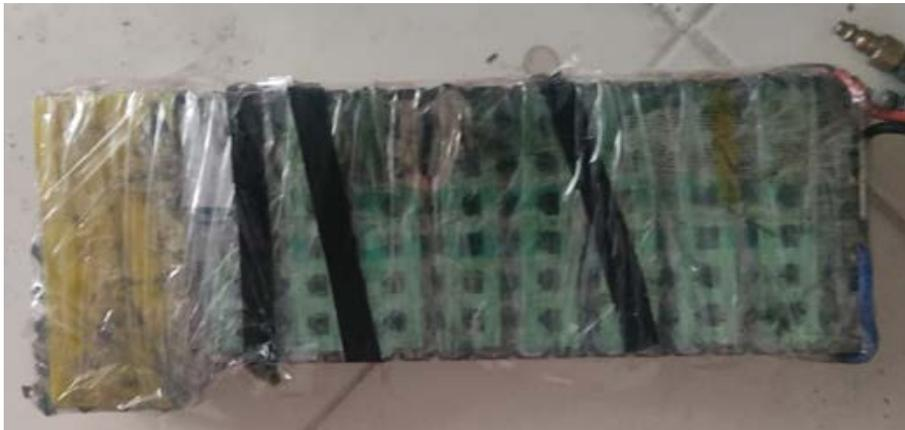
*Nota: la imagen representa el conjunto de baterías ensamblado con recubrimiento de cinta adhesiva que sirve como aislante.*
