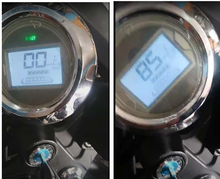
*Nota. Permite observar la velocidad máxima a la que llega QS MOTOR con el pack de baterías de 84V.*
