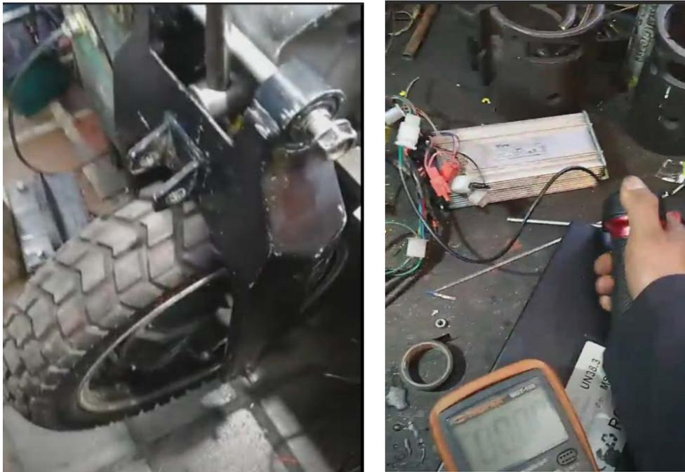
*Nota. Permite observar las conexiones con los distintos componentes para su funcionamiento antes de implementar en el chasis de la moto eléctrica.*
