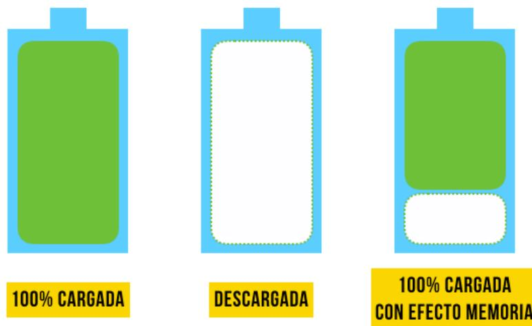
*Nota.* La Figura 23 permite observar cómo se genera el efecto de memoria en una batería cuando esta se carga desde un nivel de descarga previo. Tomado de (ReasonWhy, 2015).
