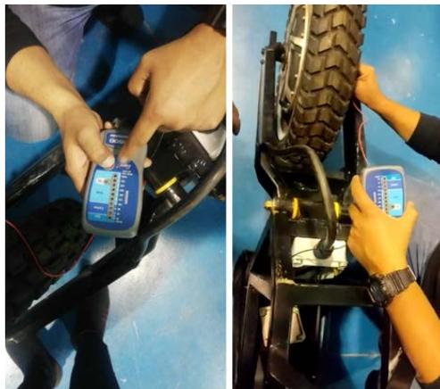
Posterior a la verificación del aislamiento se ejecutó la medición trifásica con un equipo adecuado, con el fin de obtener información detallada sobre el rendimiento y el funcionamiento del motor que cuenta con un sistema trifásico mostrando así un campo magnético giratorio que impulsa el movimiento del mismo.
