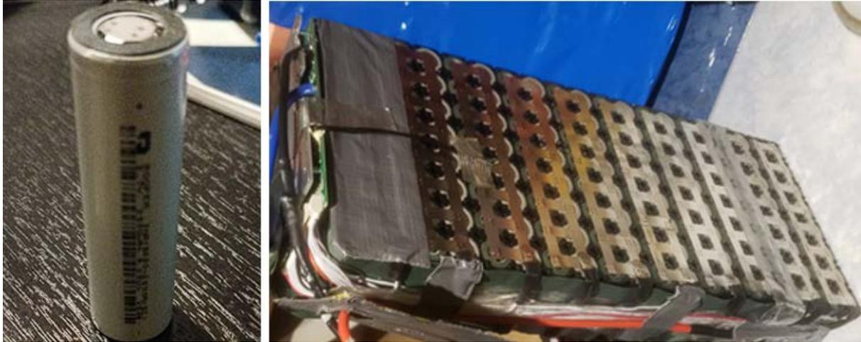
*Nota.* Permite observar el arreglo general de 140 celdas que se ha ensamblado.
