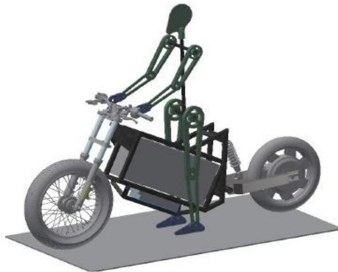
El chasis original tiene 3 simulaciones de eventos bajo condiciones específicas y estudio de esfuerzos, que son las siguientes cargas sobre el chasis: peso de la batería, peso del controlador electrónico y peso del conductor y pasajero, se muestra la asignación de cada una de las cargas con su respectivo valor.
