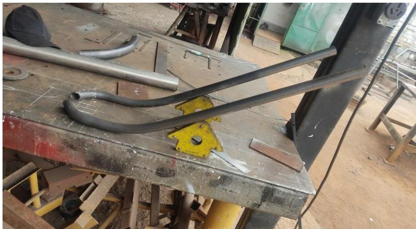
El proceso de curvatura del material debe ser meticuloso cuando se mecanizan piezas que tienen una geometría que tiene que ser generadas en sentidos opuestos y se obtienen los elementos que servirán de referencia primero, usando materiales reciclados como soporte sobre el nivel recto de una mesa, para ensamblar todo con respecto a los planos.
