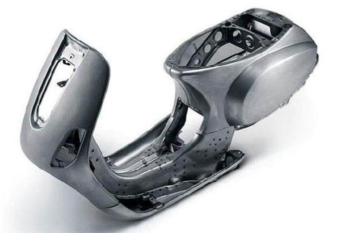
En la gran mayoría de motos de uso urbano se observa un chasis inspirado en un Chasis de Doble Cuna, para que el modelo de la moto tenga un poco más de robustez y que los soportes de los pies estén a una buena distancia de separación ya que al carecer de un motor de combustión interna no necesita tener una figura fiel al diseño tradicional, no soporta excesivo peso, vibración ni esfuerzo.
