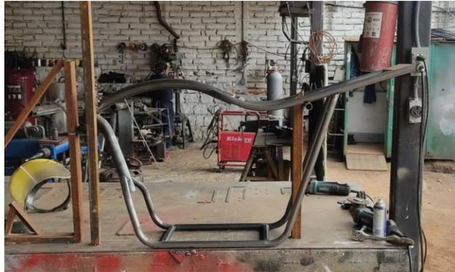
La aplicación de “puntos” de suelda es útil en la medición y de ubicación de elementos en las primeras instancias de ensamblaje, pero cuando el chasis está listo, con las medidas y longitudes estipuladas en los planos se procede a asegurar todas las uniones con la máquina de soldar tipo MIG.
