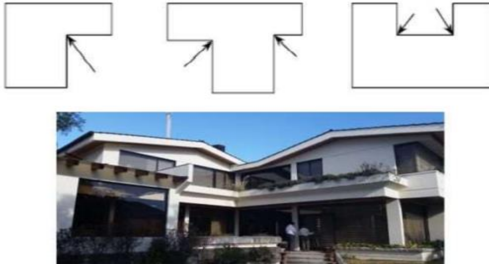
Figura No. 11. Irregularidad en planta: Configuración en planta.
