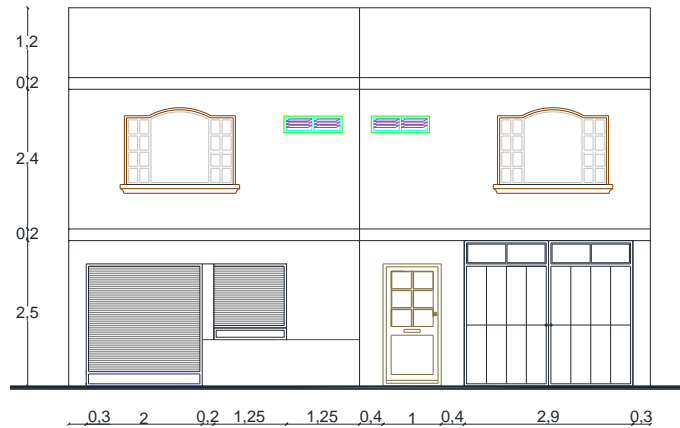
Figura No. 38. Dibujo Arquitectónico, Elevación, de Vivienda tipo.
