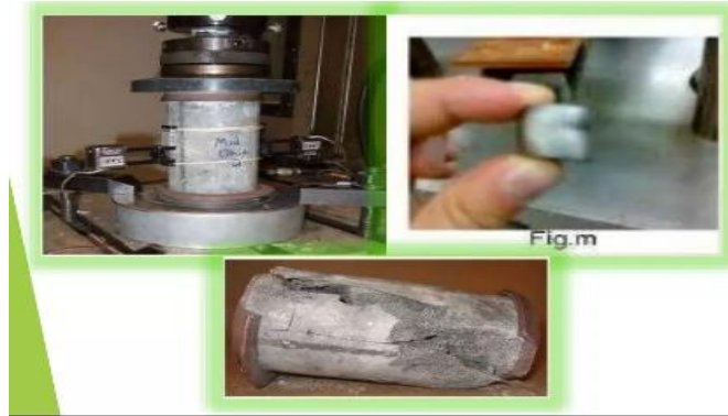
Figura No. 12. Ensayo a compresión.
