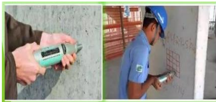
Figura No. 17. Ensayo del esclerómetro
