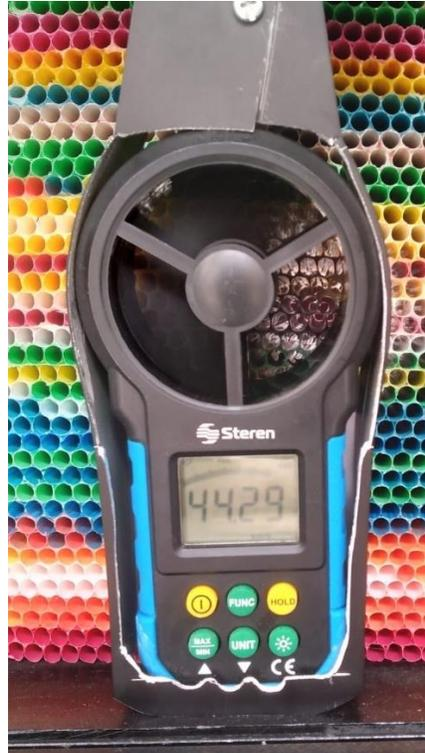
En la figura anterior muestra el mejoramiento de la velocidad de aire gracias a la ubicación del estabilizador de flujo, se utilizaron sorbetes termoplásticos donde se colocaron cada uno por encima del otro hasta conformar una estructura sólida, con ello muestra un mejoramiento aumentando la velocidad de 44 a 51 km/h.
