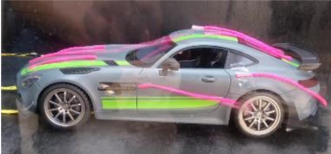
Claramente se nota como los hilos son conducidos según la forma de la carrocería y los componentes aerodinámicos, en los círculos verdes podemos observar que no existe turbulencia mientras que en el círculo rojos si presenta turbulencia y como afecta esto a la inestabilidad del vehículo.
