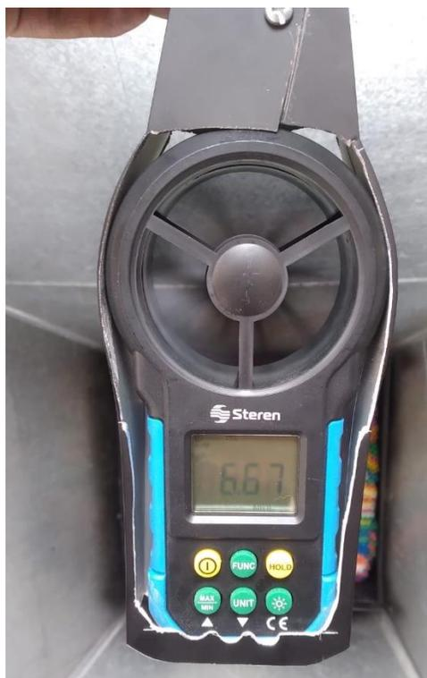
Como muestra en la figura una reducción considerable de velocidad alcanzando un 6.67 km/h y se ubica en el punto más alejado de la sección de contracción.
