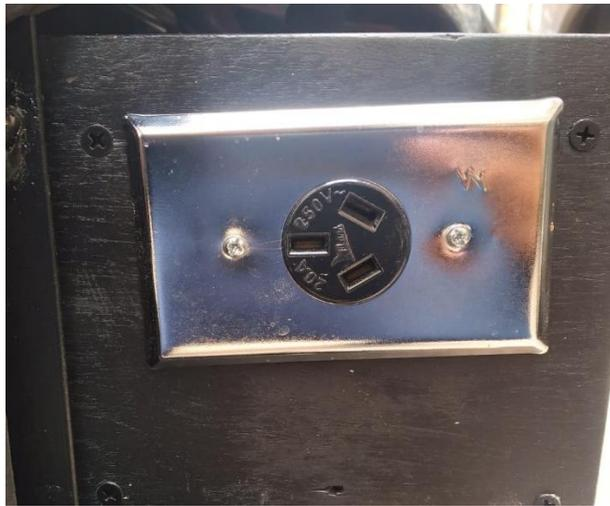
Para la figura 38 se tiene un conector perteneciente a la salida del variador, el cual se ubica en la parte posterior de la sección de prueba donde será conectado hacia el toma corriente del lugar de instalación del túnel de viento, cabe recalcar que la entrada sea solamente de 240 voltios.
