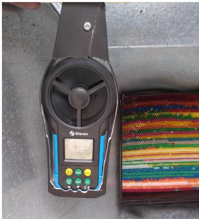
En la parte superior izquierda alcanza una velocidad de 7.66 Km/h
