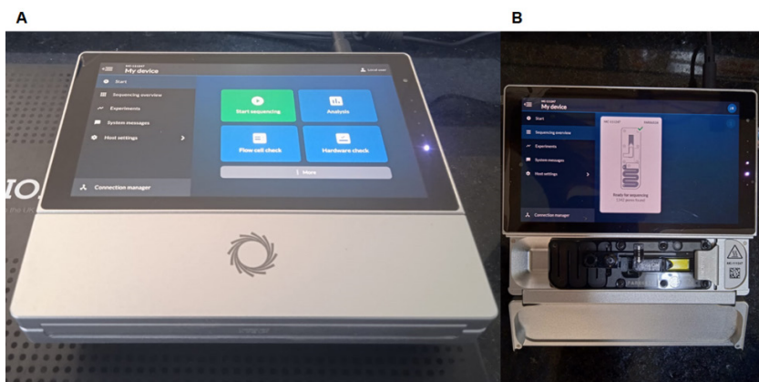
Figura 3. Equipo MiniON para secuenciación por nanoporos. A: Secuenciador de la plataforma ONT, modelo Mk1C. B: Secuenciador con el consumible flow cell incorporado. Imágenes de equipos y resultados pertenecientes a la UISEK.
