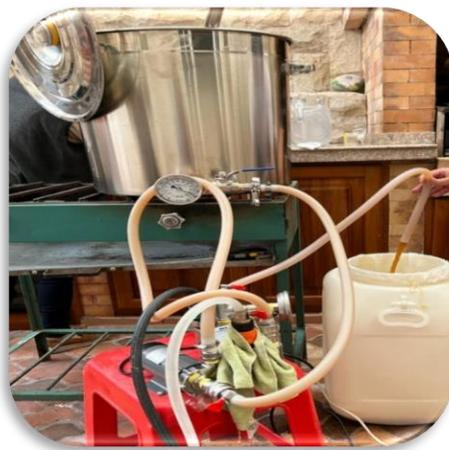
Figura 18. Enfriamiento del mosto usando un enfriador por placas.
