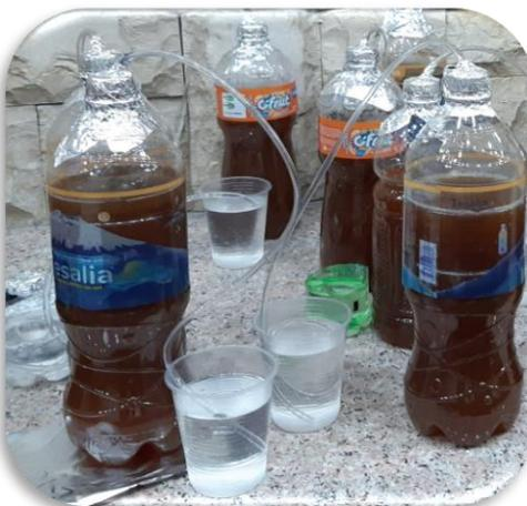
Figura 19. Fermentadores adaptados para evaluar las distintas cepas.
