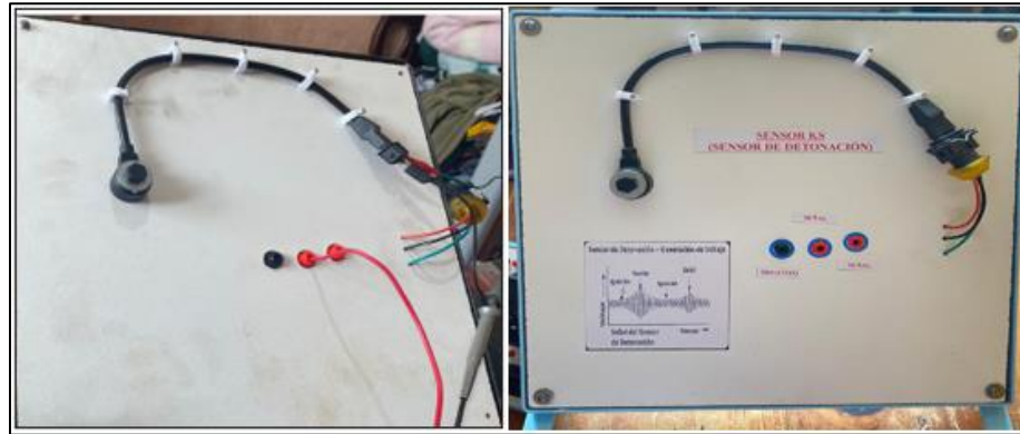
Figura 84. Conexiones eléctricas de la maqueta.
