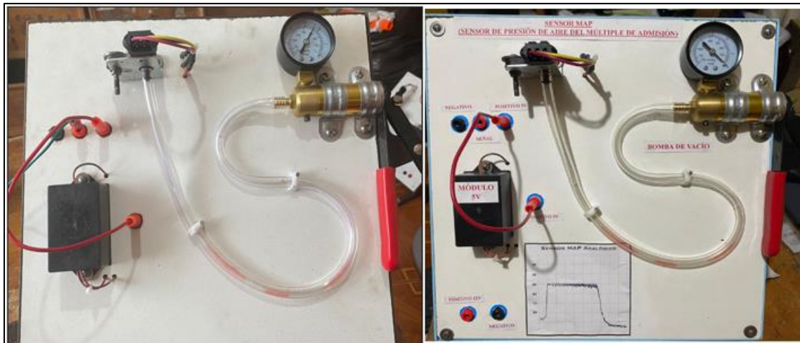
Figura 76. Conexiones eléctricas de la maqueta.
