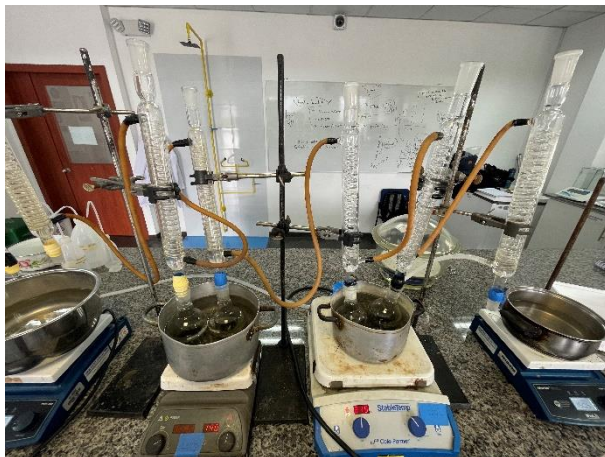
Figura 5. Equipo de reflujo constante para la extracción de ácidos grasos libres (AGL).
