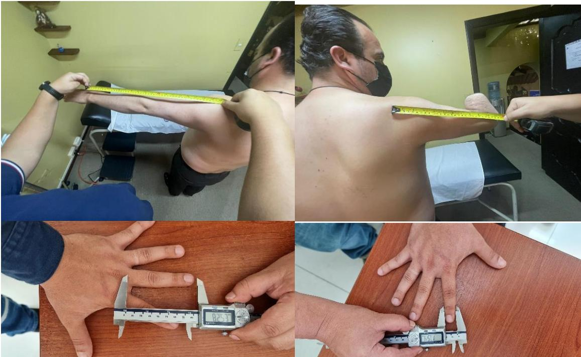
Sópalo (2019), menciona que para aportar orden y control en la obtención de longitudes de todos los eslabones que deben ser considerados para en la etapa de diseño de la prótesis de mano y antebrazo, Vaca (2017), también indica que se debe realizar un mapeo de medidas acorde a la norma DIN 33402-2, que especifica la manera de toma de medidas estándar del cuerpo humano tal como se muestra en la Figura 45.
