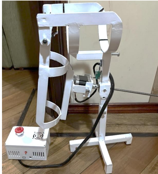
Figura 24: Estructura metálica del prototipo del exoesqueleto.
