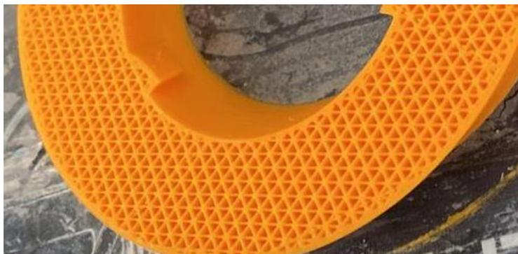
Se realizaron prototipos iniciales bajo las especificaciones indicadas por el fabricante con intervalos de 5°C, como es el caso del PLA material con el cual se trabajó bajo las condiciones de temperatura del fabricante de 195°C a
