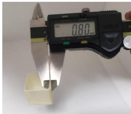
Posterior a la calibración de flujo para el PVA se realizó la creación de los prototipos que serían analizados para lo cual se tomaron medidas referentes a largo, ancho y altura para validar el resultado obtenido y estos resultados se
