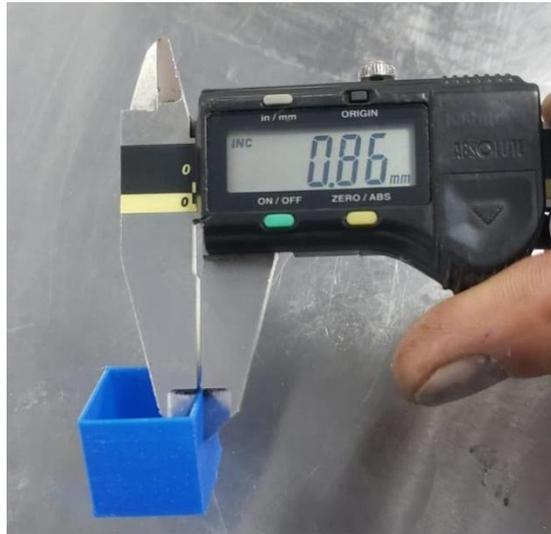
Una vez realizada la configuración inicial se obtiene un resultado de 0.86mm como se muestra en la Figura 24 donde se observa que el espesor de la pared del cubo impreso en TPU fue superior esto quiere decir que el porcentaje de flujo fue elevado por lo tanto al realizar un cálculo proporcional para encontrar el porcentaje de flujo a adecuado se determina que:
