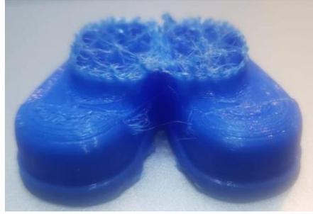
Adicionalmente se encontró que es mucho más difícil crear objetos con bajos porcentajes de relleno debido a que se está utilizando un material flexible y este a su vez requiere de superficies de apoyo para mantenerse en el sitio que se desea durante el proceso para respaldo de lo antes mencionado se muestra la Figura 58 donde observamos que el objeto no se pudo imprimir debido a que él porcentaje de relleno fue inferior a 20% y con una velocidad de impresión de 40mm/s.
