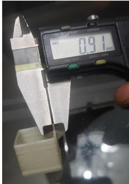
Una vez realizada la configuración inicial se obtiene un resultado de 0.91mm como se muestra en la Figura 25 donde se observa que el espesor de la pared del cubo impreso fue superior esto quiere decir que el porcentaje de flujo fue elevado por lo tanto al realizar un cálculo proporcional para encontrar el porcentaje de flujo adecuado se determina que:
