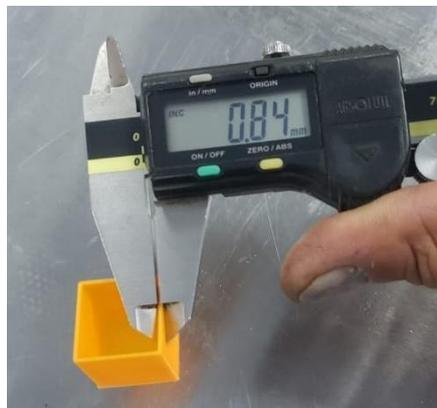
Una vez realizada la configuración inicial se obtiene un resultado de 0.84mm como se muestra en la Figura 23 donde se observa que el espesor de la pared del cubo impreso en ABS fue superior esto quiere decir que el porcentaje de flujo fue elevado por lo tanto al realizar un cálculo proporcional para encontrar el porcentaje de flujo adecuado se determina que:
