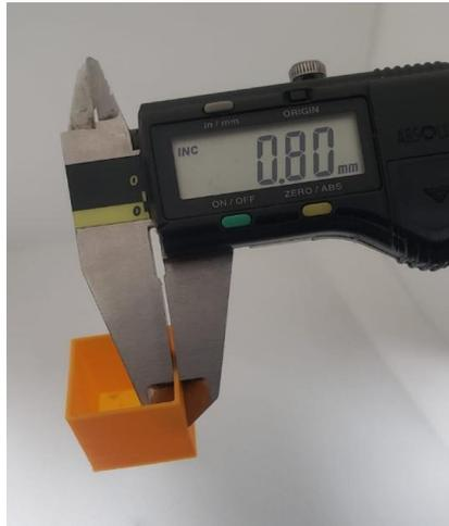
Después de realizar el ajuste de flujo se procede a tomar las medidas de los cubos que se realizaron y para esto se muestra la Tabla 7 donde se puede observar los datos referentes a las tres medidas básicas de un cubo además de los valores mínimos máximos y el promedio de las medidas obtenidas
