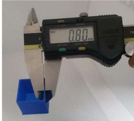
La calibración de flujo para el TPU se lo realizo durante todo el proceso de creación de los prototipos con lo cual se llegó a validad las dimensiones referentes a largo ancho y alto de un cubo para lo cual se presenta la Tabla 8 donde se muestra las medidas obtenidas.
