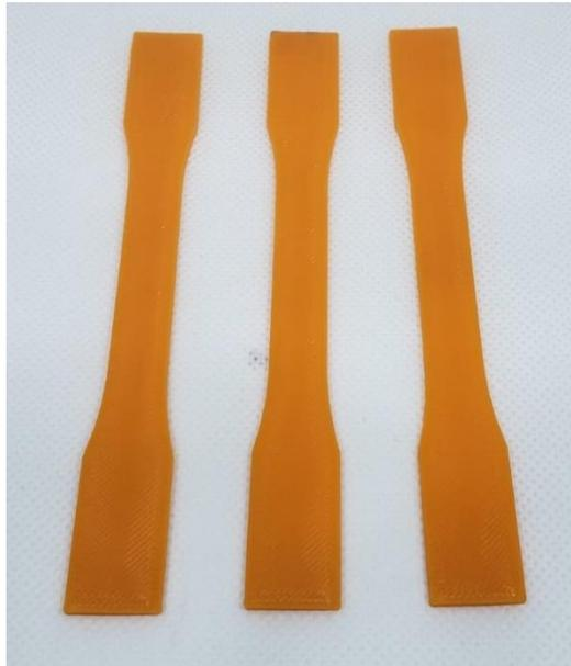
En la Figura 56 se puede visualizar las probetas realizadas para el análisis tomando en cuenta como resultado previo los valores obtenidos, donde se puede observar menor número de imperfecciones en lo referente a adherencia, por otra parte, las temperaturas a las cuales se trabajó fueron de 260°C a 270°C con intervalos de 5°C. En la tabla 18 se podrá visualizar en análisis micrográfico de las probetas realizadas al 100% de relleno con una velocidad de impresión de 60mm/s.
