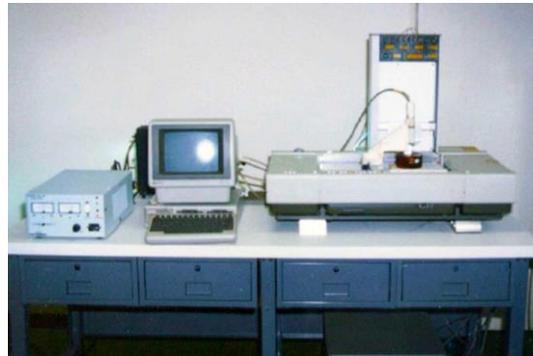
*Nota: La Figura 1 muestra una de las primeras impresoras en 3D bajo el principio de estereolitografía proceso con el cual se imprime capa a capa hasta reproducir el objeto que se desea realizar (López, 2019)*
