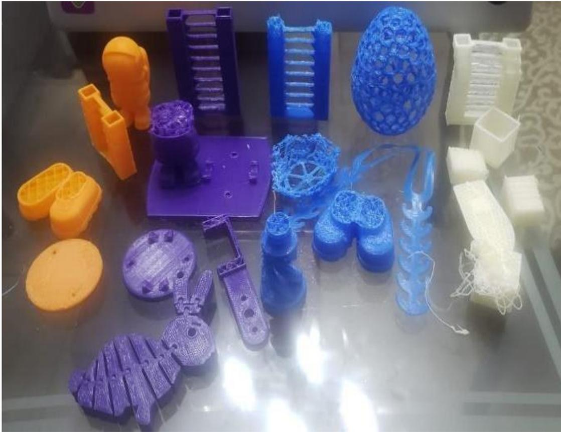
En proceso se determinaron puntos críticos que se relacionan con el comportamiento de cada material utilizado como por ejemplo la velocidad, la temperatura de extrusión como la temperatura de la cama, parámetros que son planteados dentro del análisis del presente trabajo. Además, para lo cual también se llegó a caracterizar el nivel de dificultad de impresión mediante la representación de la siguiente Tabla 15
