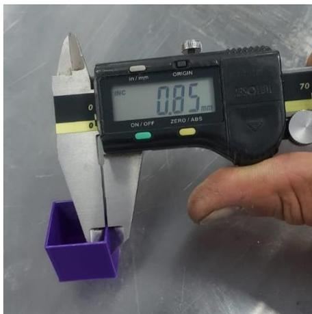
Una vez realizada la configuración inicial se obtiene un resultado de 0.85mm como se muestra en la Figura 22 donde se observa que el espesor de la pared del cubo impreso en PLA fue superior esto quiere decir que el porcentaje de flujo fue elevado por lo
