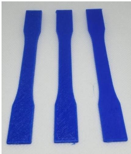
En la Figura 59 se pueden visualizar las probetas realizadas para el análisis de resultados con base en la Tabla 20 seleccionando las temperaturas que presentaron mejor rendimiento en lo referente a la adherencia entre las capas.
