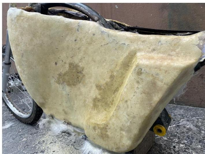
Una vez aplicadas todas las capas de fibra de vidrio necesarias al igual que en el caso de la tapa de la computadora de gestión del motor, se aplicó masilla para crear una superficie lo más uniforme y lisa posible para poder aplicar fondo de relleno automotriz, aplicación de masilla roja y terminar de preparar las piezas para la aplicación de pintura y barniz. La figura
