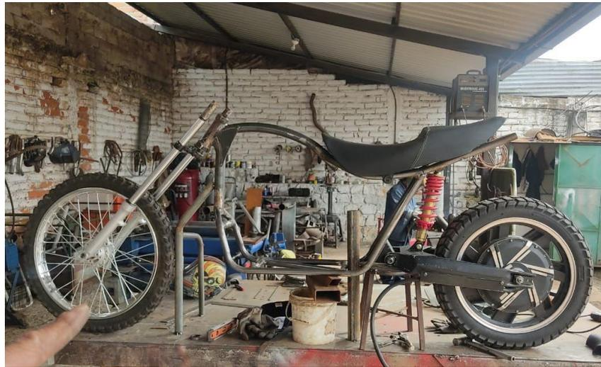
Con el chasis modificado se procedió a modelar el mismo de acuerdo con sus dimensiones dentro del software Altair Inspire Studio con el fin de sobre este utilizar la herramienta “Wheelarch” con “Polynurbs” para la construcción del carenado para la motocicleta con su estructura final.
