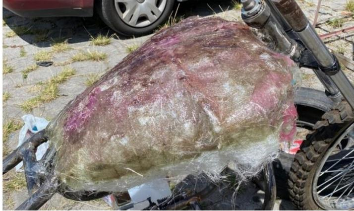
Por esta razón, las demás piezas se decidieron construir con la ayuda de espuma poliuretano de expansión, creando así un molde mucho más firme sobre el cual colocarse la fibra de vidrio, ayudando a reducir potencialmente las irregularidades en la capa final, permitiendo acelerar el proceso de construcción del carenado.
