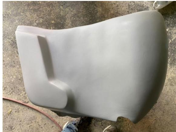
En la figura 45 se observa la aplicación de la primera capa de fondo de relleno automotriz.
