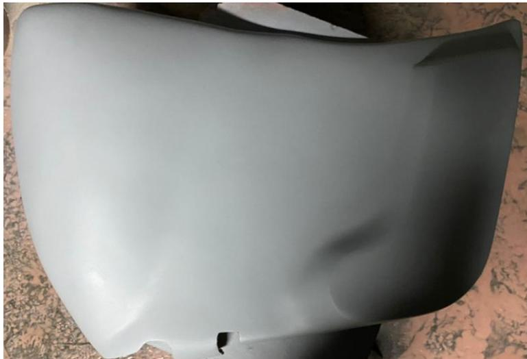
En la figura 47 se observa la pieza del carenado frontal izquierdo aplicadas las capas de fondo necesarias para la aplicación de la pintura.
