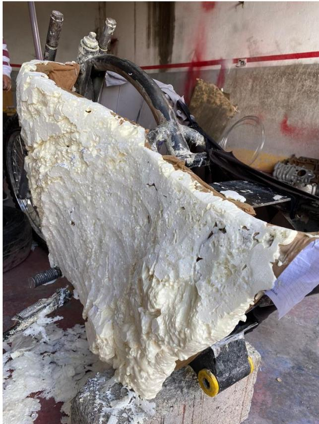
En la figura 41 se aprecia la aplicación de la espuma para la creación del molde del carenado lateral de la motocicleta, aquí se comenzó a dar forma con cuchillas y se identificaron las zonas en las cuáles era necesario aplicar más espuma.
