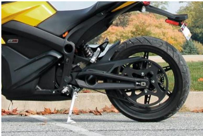
*Nota.* La figura 2 muestra una motocicleta que cuenta con un motor eléctrico que acciona la rueda trasera de la motocicleta mediante una cadena. Tomado de *Motocicleta Eléctrica* [Fotografía], por JF, 2021, Twenergy (<https://twenergy.com/coches-electricos/guia-precios-motos-electricas/>).
