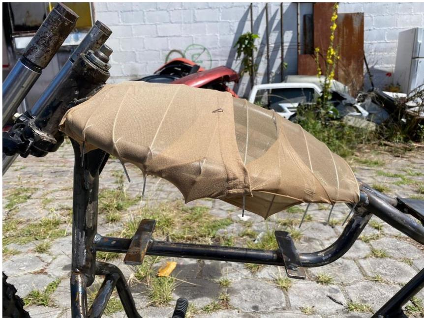
*Nota.* Este molde fue creado con el uso de alambre y media nylon sobre la estructura metálica de la motocicleta.
