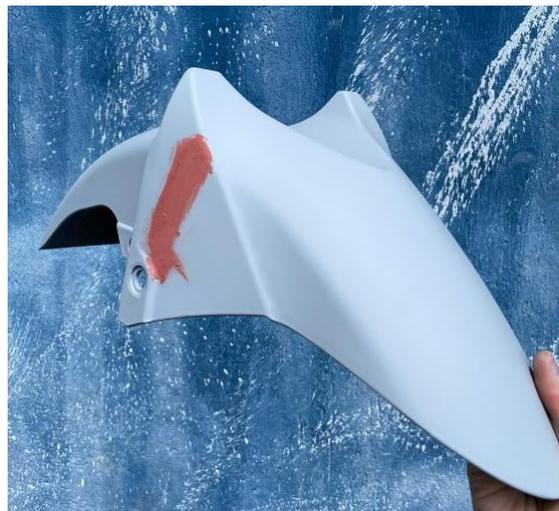
La figura 98 muestra la pieza del guardabarros frontal con la aplicación del fondo de relleno y la masilla roja automotriz.
