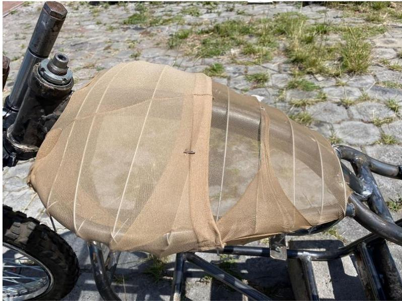
En la figura 40 se muestra la creación del molde de la tapa de la computadora de gestión del motor con el uso del alambre y la tela o media nylon.
