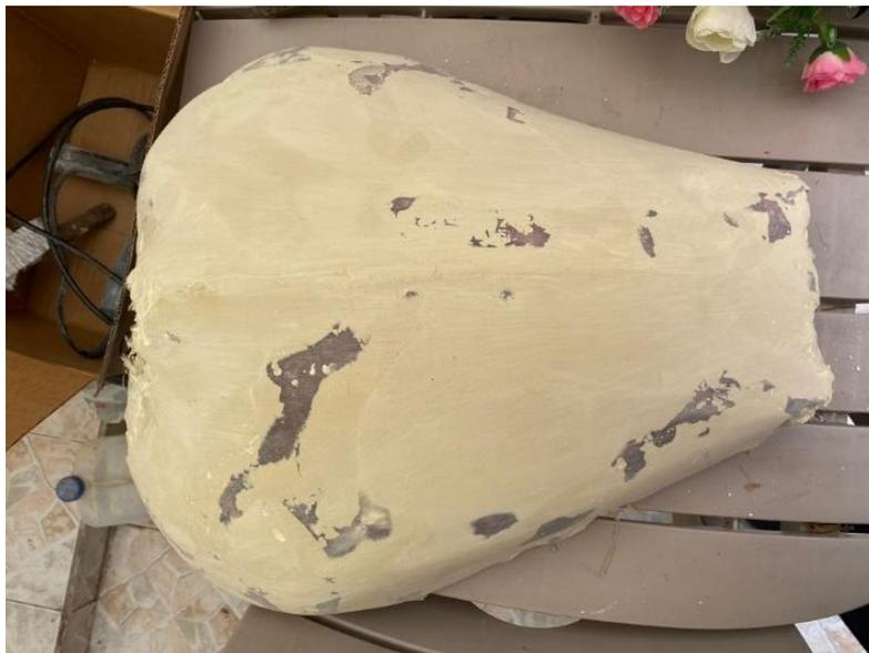
Con la superficie lisa y nivelada se procedió a aplicar las capas de fondo correspondientes, lijar la superficie y la aplicación de masilla roja automotriz para la corrección de las últimas irregularidades que puedan quedar sobre la pieza y nuevamente lijar la superficie para dejar la pieza lista para la aplicación de pintura.
