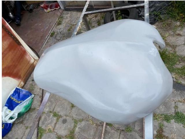
Una vez preparada toda la superficie y aplicado el fondo, se procedió finalmente a aplicar todas las capas de pintura y barniz necesarias para que la pieza tenga un acabado brillante y resistente a fenómenos externos como el sol y la lluvia.
