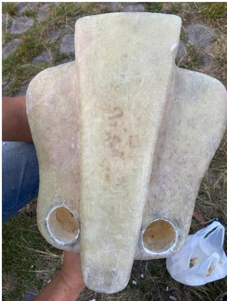
Una vez que ya se aplicaron todas las capas de fibra de vidrio, se procedió a aplicar la masilla para preparar la pieza para la aplicación de fondo y posteriormente corregir todas las fallas restantes con masilla roja automotriz y así dejar lista la pieza para aplicar pintura y
