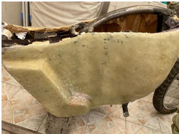
Como se puede apreciar en la figura 107, perteneciente a los paneles laterales de la motocicleta se pudo obtener una pieza con una superficie mucho más lisa, reduciendo así la utilización de materiales como masilla polimérica, acelerando así el proceso de preparación de
