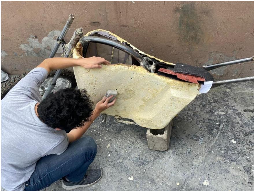
En la figura 42 se aprecia el lijado de la superficie del molde, con el fin de eliminar la mayor cantidad de imperfecciones e irregularidades y de esta forma crear una superficie lisa para la aplicación de la fibra de vidrio.
