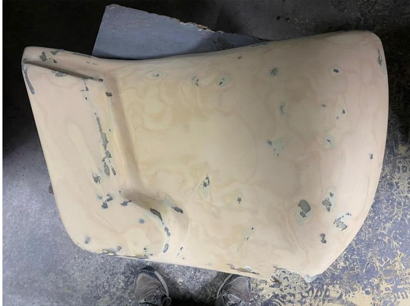
En la figura 44 se observa el estado final de la superficie de fibra de vidrio una vez lijada toda la masilla poliéster empleada para la creación de una superficie lisa adecuada para la aplicación de fondo de relleno automotriz.
