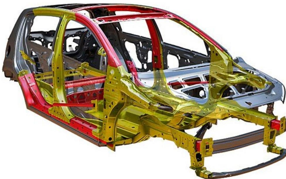
*Nota:* Adaptado de clases de acero de la carrocería del Chevrolet Sail 2018 (gráfico), Body Structure Chevrolet Sail (GM Motors, 2018).
