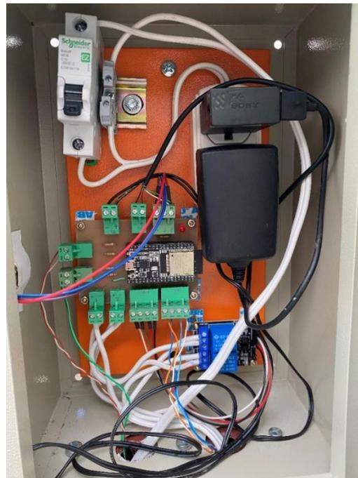
*Figura 34 Conexión interna de los dispositivos del módulo centralizador.*
