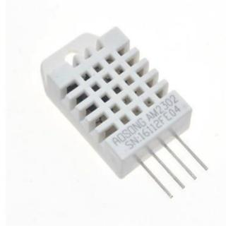
*Figura 4 Sensor DHT22*
