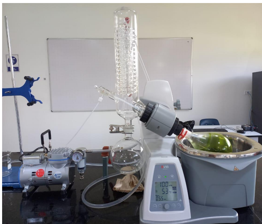
Anexo 2. Destilación de extractos metanólicos en un rotavapor RE100-Pro
