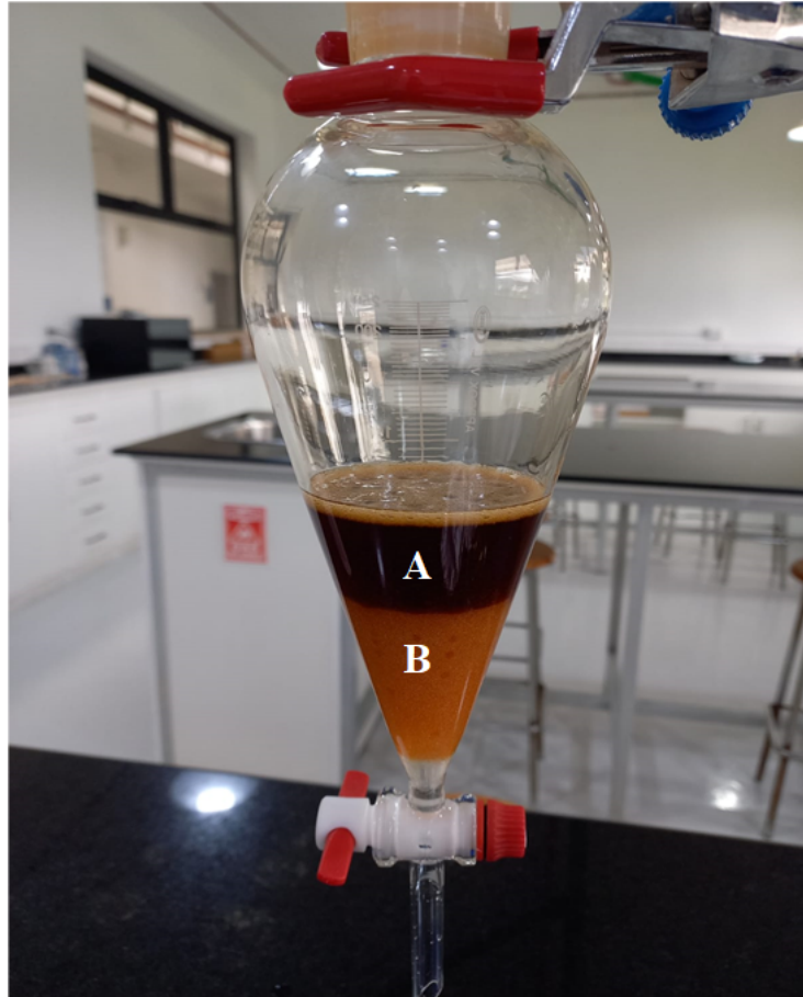
Anexo 3. Decantación de los extractos (chuquiragua) en la fase Extracto líquido líquido A) sobrenadante B) extracto clorofórmico
