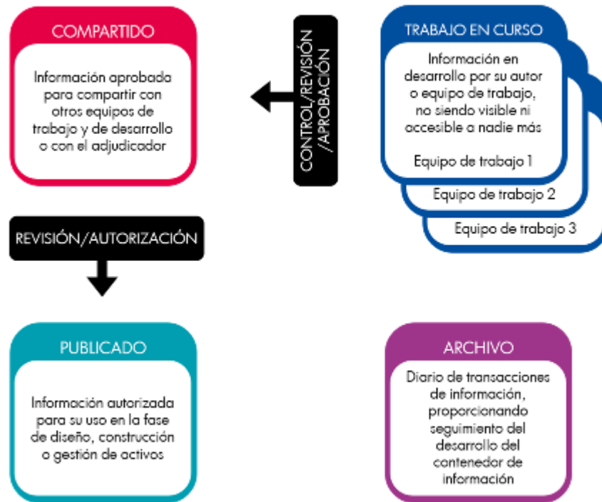
Figura 9. Concepto de Entorno Común de Datos (CDE) Tomado de: BUILDING SMART (2021). Introducción a la ISO 19650
