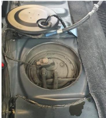
7. Se conecta la manguera del tanque de presión a la entrada de combustible en el sistema de combustión (figura 29).
