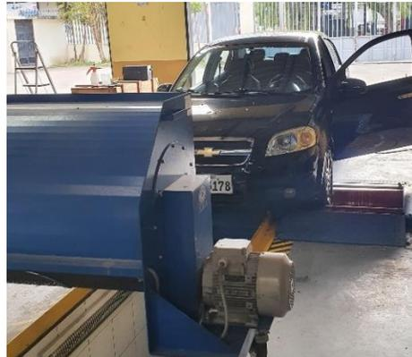
4. Una vez que el vehículo está posicionado en el dinamómetro, este debe ser anclado para evitar que se mueva de su lugar actual, en la figura 26 se muestra el anclaje con correas a piso y mesas del vehículo.
