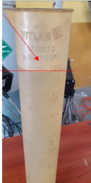
14. Con el excedente del combustible en el matraz de 5000ml se complete a su marca máxima con el matraz llenado con 1000ml de combustible, la cantidad marcada después en el matraz de 1000ml será el consumo (figura 36) en una prueba del ciclo IM240.
