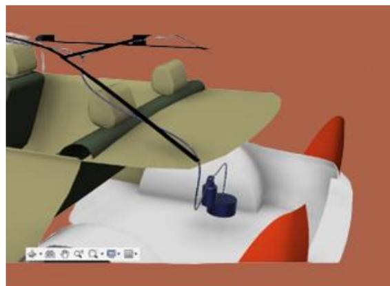
*Nota.* Instalación de la Bomba de Presión del Sistema de Sanitizante en el Maletero del Auto
