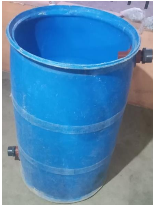
Fotografía N° 19 Entrada y salida del filtro.
