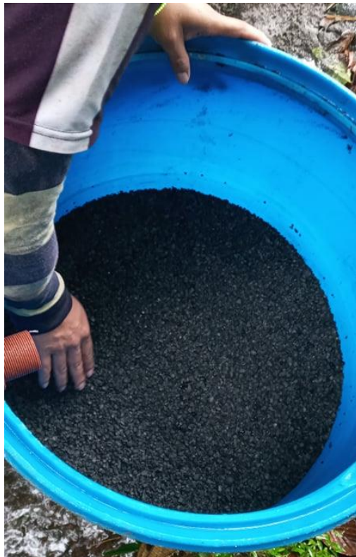
Fotografía N° 25 Capa de carbón activo granular.
