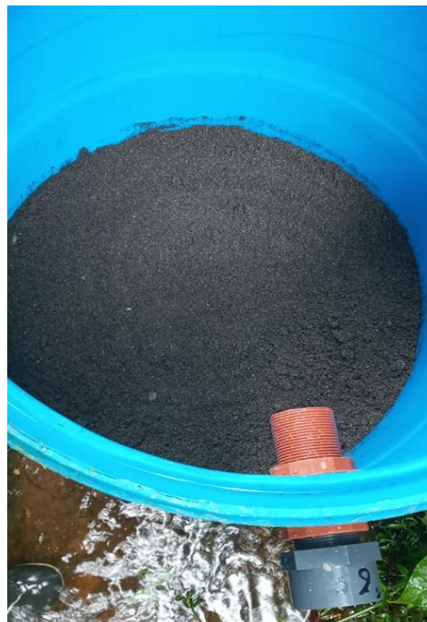
Fotografía N° 24 Capa de arena gruesa.
