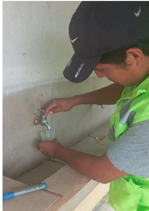
Fotografía N° 30 Toma de muestra en grifo - agua cruda.
