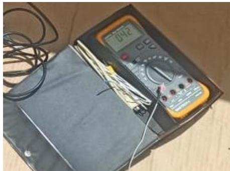
*Nota:* Fotografía multímetro medición de temperatura con termocupla.
