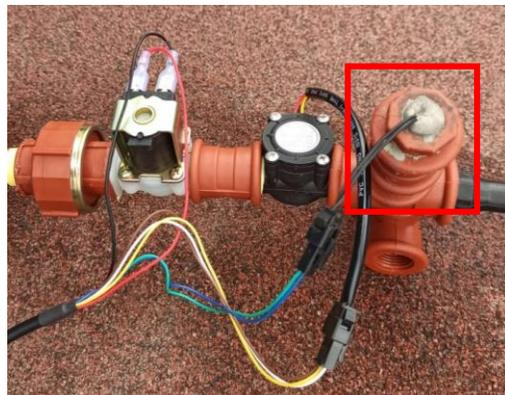
*Nota:* Fotografía válvula solenoide, caudalímetro y sensor de temperatura (enmarcado)
