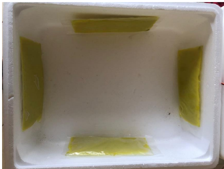
Figura 16 Contenedor con la primera combinación de distribución de PCM
