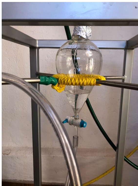
Figura 14 Extracción aceite de semilla de aguacate maduro
