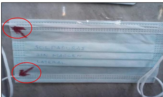
La mascarilla de la figura 23 muestra la soldadura en lado interno, la cual debe estar en el lado externo de la mascarilla generando un defecto de calidad.
