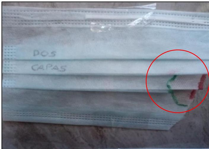
Desde la figura 20 hasta la figura 25 muestran los defectos ocasionados por la máquina de mascarillas. La mascarilla de la figura 20 muestra el defecto de mascarilla con margen excesivo ocasionando disfuncionalidad al no acoplarse la mascarilla a la cara.
