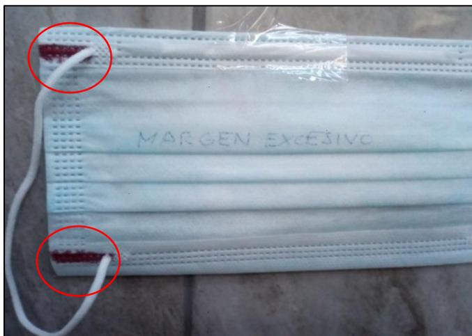
La mascarilla de la figura 21 muestra el defecto con soldadura sobrepuesta, la cual es ocasionada cuando se reprocessa una mascarilla.
