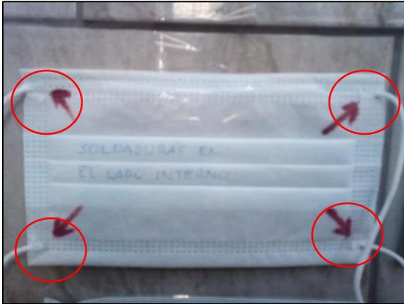
Las mascarillas de la figura 24 muestran defectos de soldado del elástico al cuerpo de la mascarilla debido a mal posicionamiento en la alimentación de la máquina de soldado.
