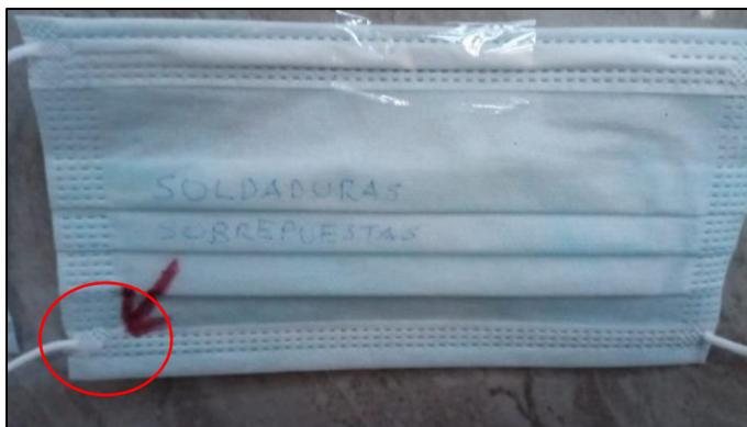
La mascarilla de la figura 22 muestra el defecto de soldadura sin margen lateral lo que ocasiona que se rompa el elástico con una mínima fuerza.
