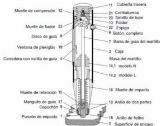
FIGURA 20 Componentes del esclerómetro. FUENTE: (Lozano, 2014).
