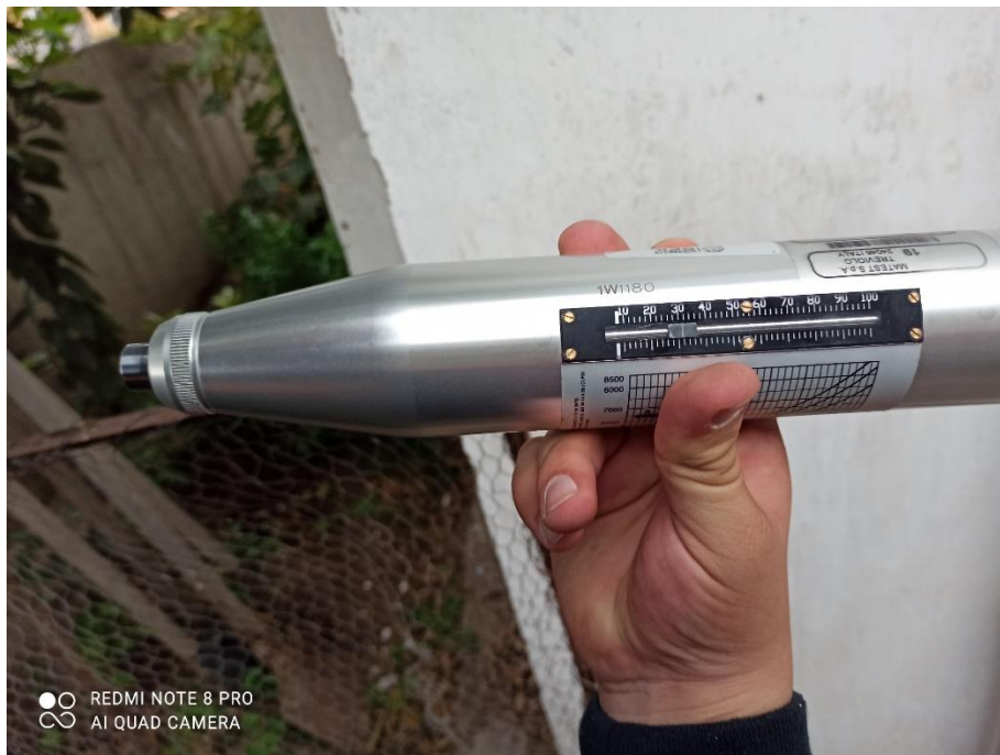
Figura 116 Nivelación de esclerómetro
