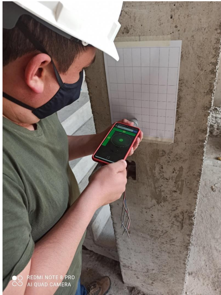
Figura 116 Nivelación de esclerómetro
