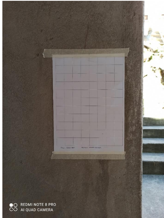
Figura 113 Colocación de Malla de 25 mm
