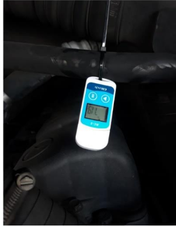
Figura 27. Instalación del Datalogger habitáculo del motor Recuperado. Fuente propia
