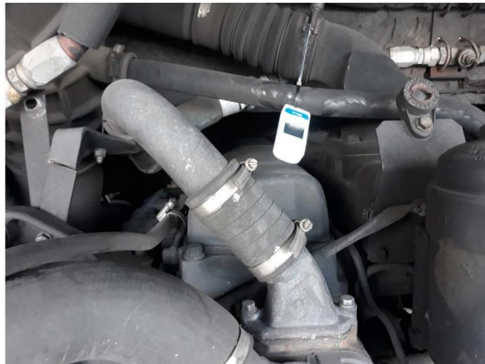
Figura 28. Instalación del Datalogger funcionando. Recuperado. Fuente propia
