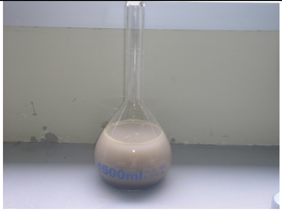
Foto 12: Determinación de la gravedad específica de los agregados finos.
