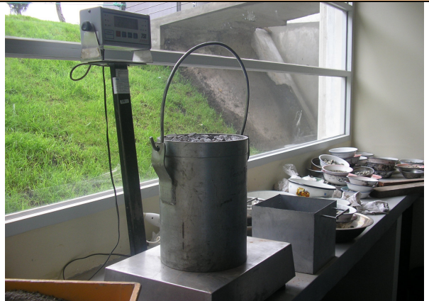
Foto 10: Determinación del peso unitario del agregados finos
