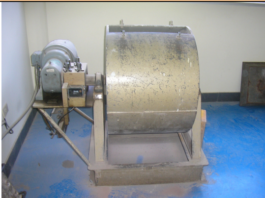
Foto 13: Determinación de la resistencia al desgaste de los agregados gruesos (máquina de los ángeles).
