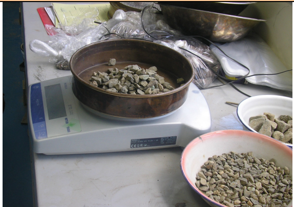
Foto 14: Determinación del contenido de humedad natural.
