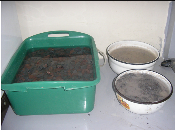
Foto 11: Determinación de la gravedad específica de los agregados finos y gruesos.
