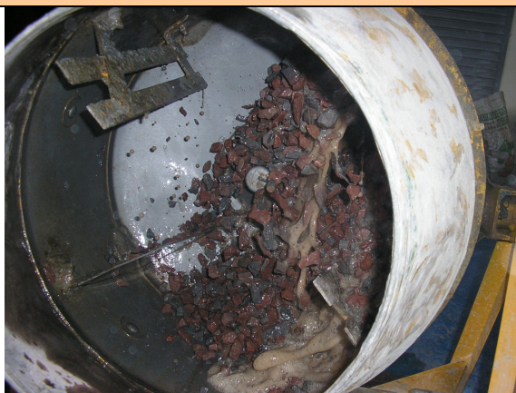
Foto 19: Mezcla de los componentes del hormigón.
