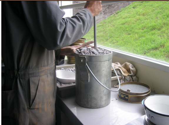
Foto 9: Determinación del peso unitario de los agregados gruesos
