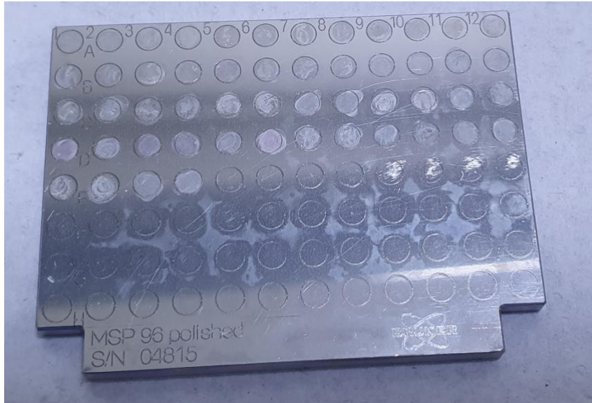
Figura 2. Placa metálica sobre la que se coloca la muestra para la desorción/ionización mediante laser.
