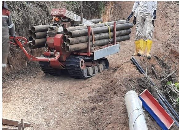
Foto # 1: Transporte de equipos y materiales con mulas a plataforma para sondaje en exploración inicial.
