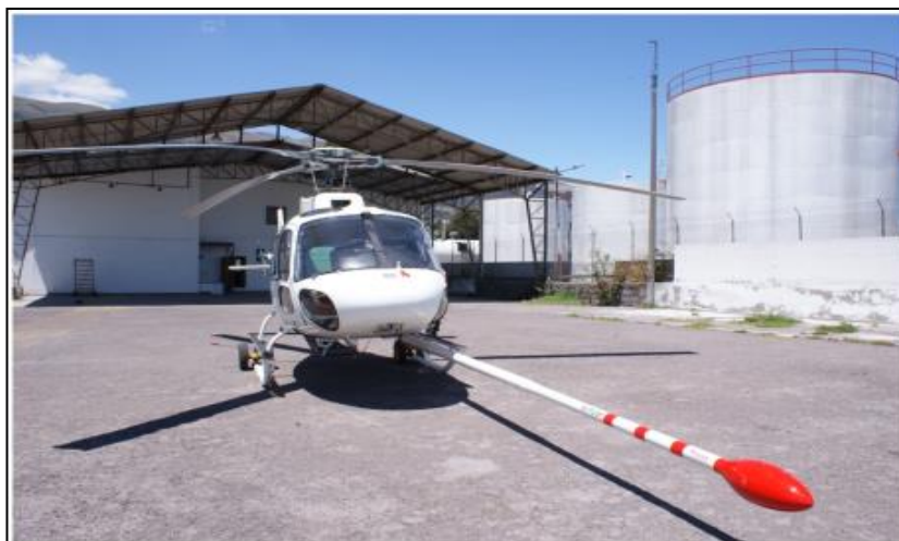
Ilustración 3 Aeronave adecuada con Magnetómetro
