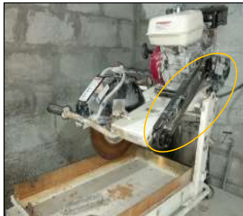
Fotografía 9 Correa y polea sin protección Fuente: Empresa Brown Rock Resources S.A
