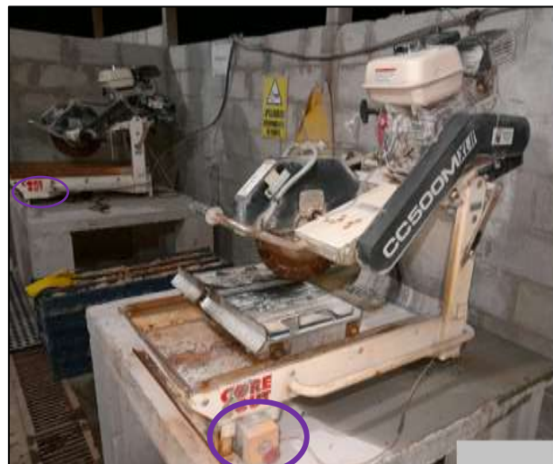
Fotografía 5 Cortadora de testigos de roca con parada de emergencia Fuente: Empresa Brown Rock Resources S.A
