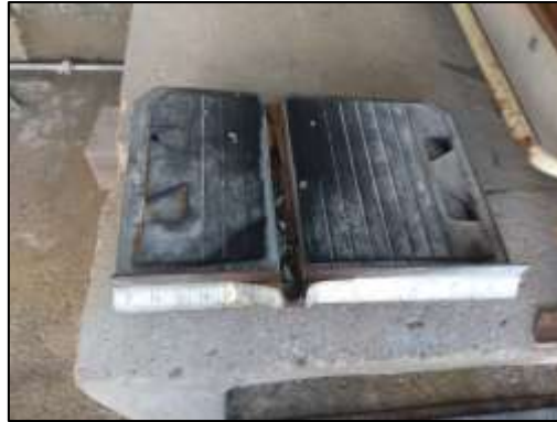
Fotografía 7 Carro transportador roto, sin superficie regular y sin bloque guía Fuente: Empresa Brown Rock Resources S.A
