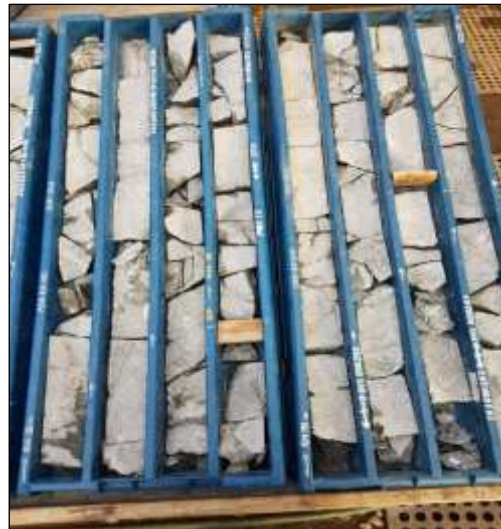
Fotografía 2 Cajas con testigos de perforación cortados y muestreados Fuente: Stregth Int y E.A. Minerals
