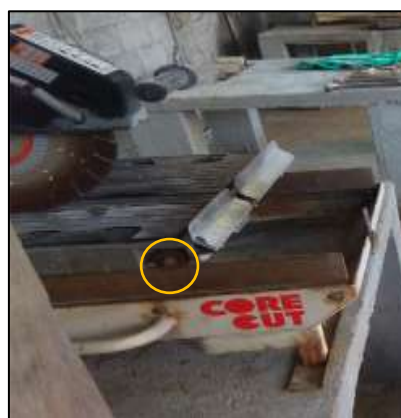
Fotografía 6 Poléa de carro transportador oxidada Fuente: Empresa Brown Rock Resources S.A
