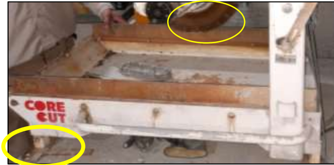
Fotografía 4 Cortadora de testigos de roca sin anclajes y con disco de corte oxidado Fuente: Empresa Brown Rock Resources S.A
