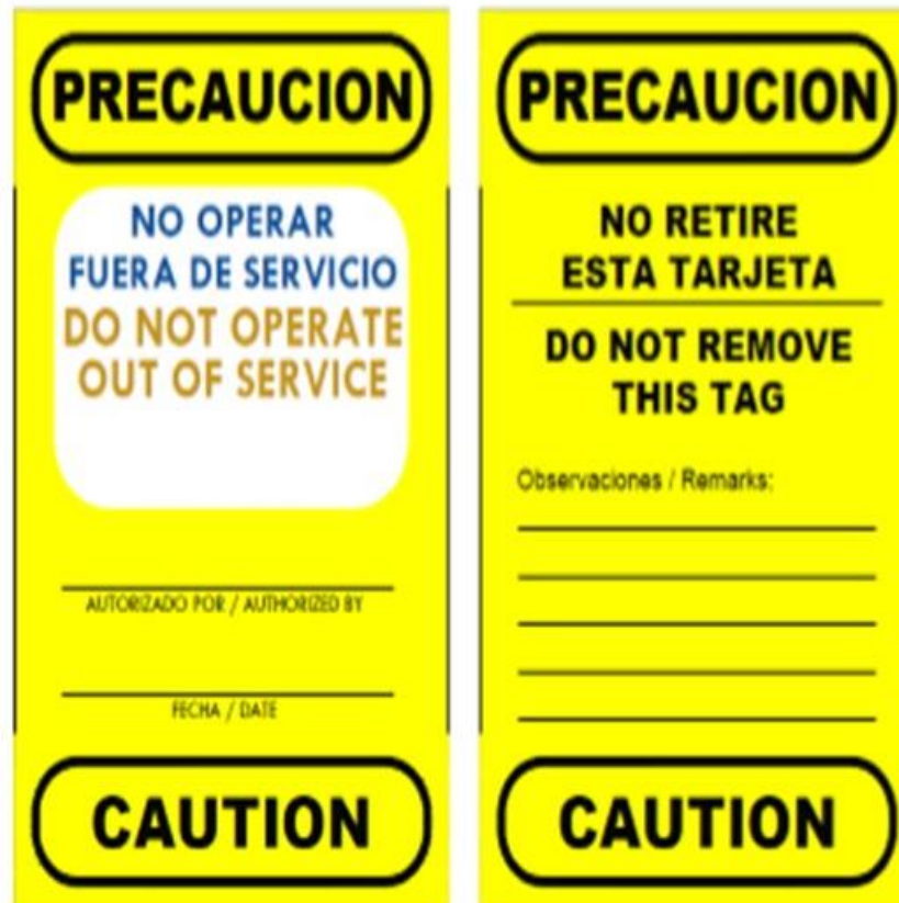
Imagen 15. Tarjeta de Protección de Equipos Fuera de Servicio
