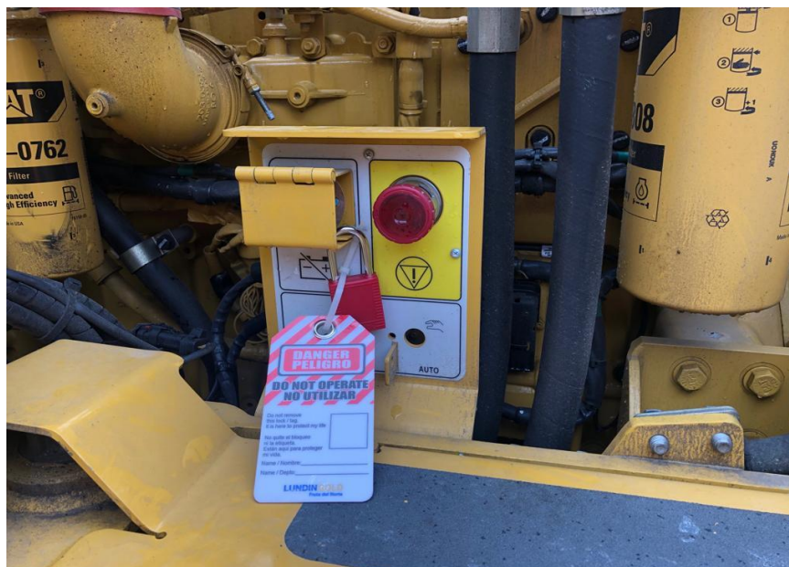
Imagen 4. Ejemplo de bloqueo con etiqueta y candado
